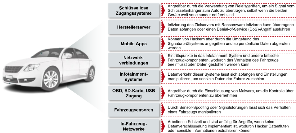
Abbildung 2: Für Hackerangriffe vulnerable Stellen im Fahrzeug
